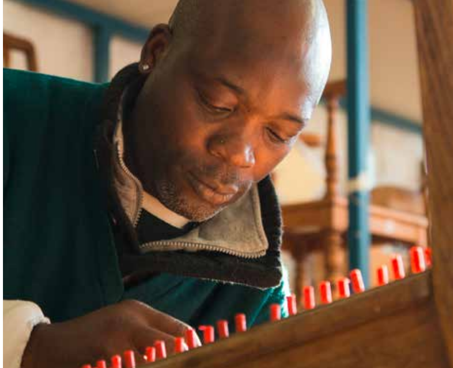
In der Werkstatt für Möbelaufbereitung werden Stühle mit geflochtenen Sitzflächen und Lehnen repariert. Die Geflechterneuerung erfordert viel Geschick und Fingerspitzengefühl.
